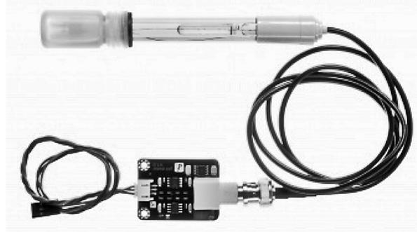
**Figura 8.** Sensor de PH de dfrobot.
