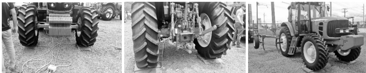
Figura 3. Práctica de balanceo estático para un lastrado correcto de tractor agrícola para un cultivo de piña en Muelle de San Carlos (Foto cortesía: MATRA)
