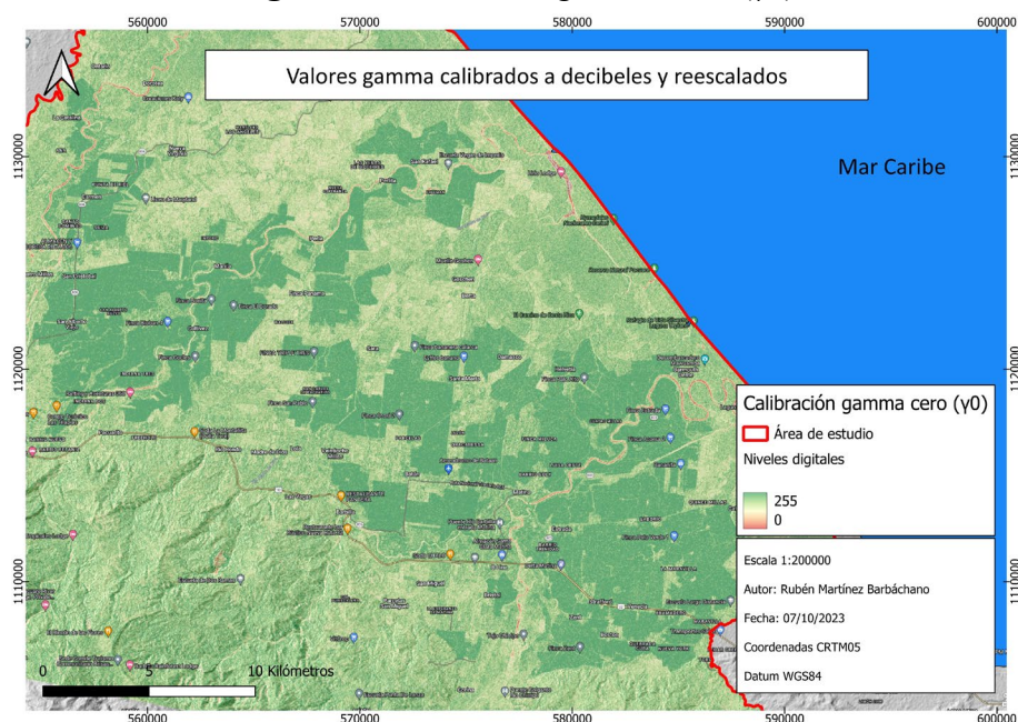
Figura 4. Calibración gamma cero ( \gamma_0 )
