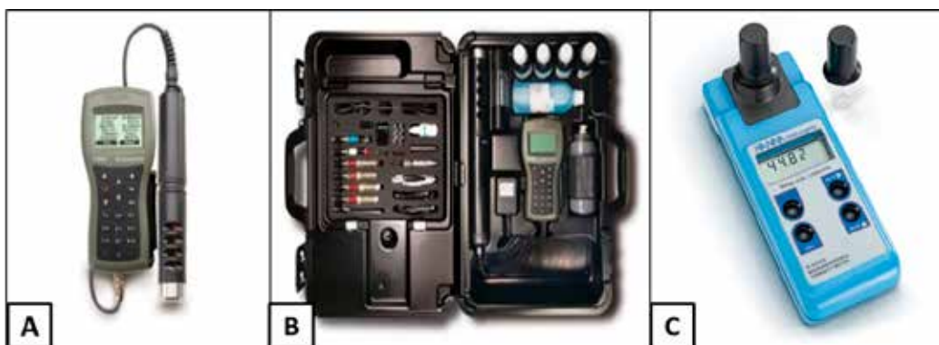
Figura 7 - Sonda multiparamétrica (A e B) e medidor de turbidez (C) utilizados para medição de variáveis físico-químicas.
