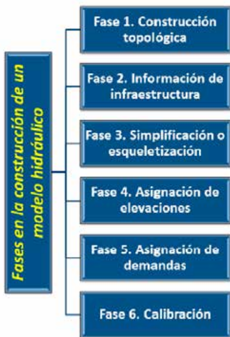
Figura 5. Fases en la construcción de un modelo hidráulico confiable.
