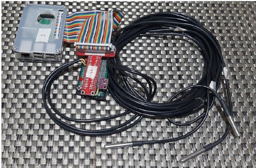
Figura A2: Hardware, circuitería y cableado del laboratorio remoto
