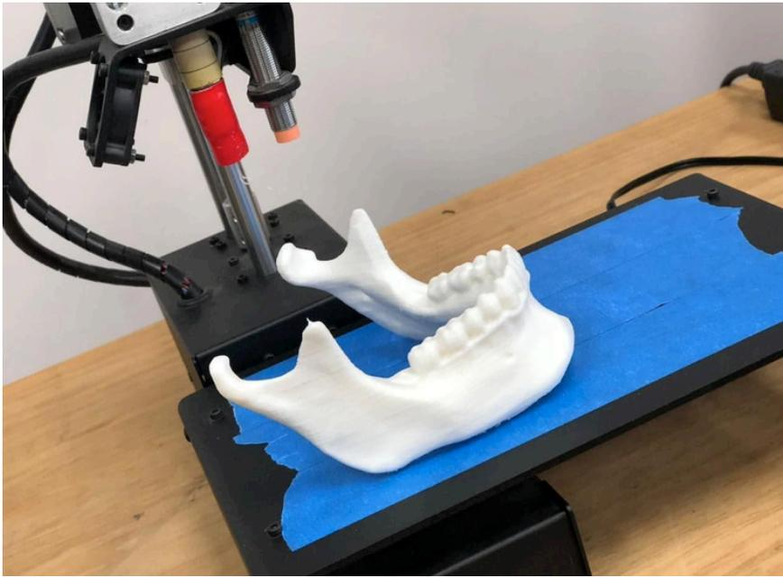
**Figura 4.** Impresora 3D Printrobot Simple Metal.
