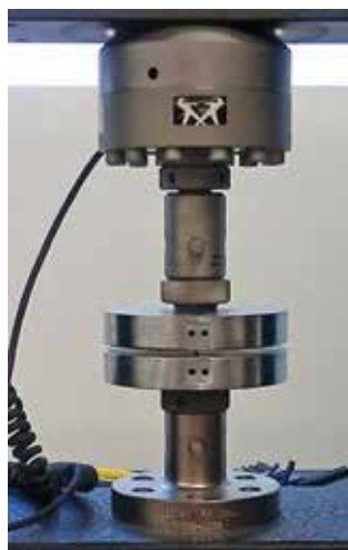
Figura 3. Dispositivo para prueba de compresión marca Instron® modelo 3382 (USA).
