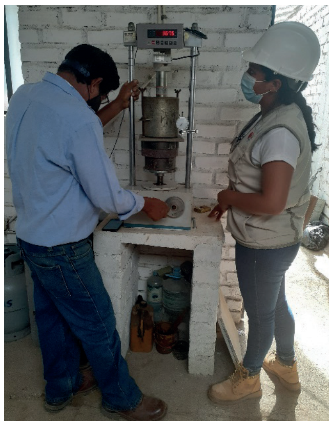
Figura 4. Ensayo del Valor de soporte de California (CBR) del suelo cohesivo con la vinaza (Fase II)
