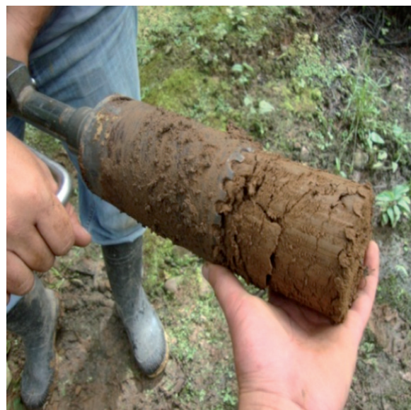
Figura 1. Muestreo de las raíces de la palma aceitera utilizando un barreno de barril semejante a los de Eijkelkamp. Coto 47, Buenos Aires, Puntarenas, Costa Rica. Agosto del 2012.
