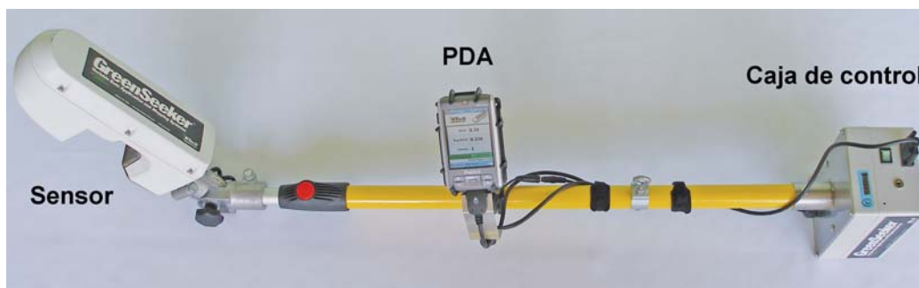
Figura 4. Modelo RT100 (NTech, California, EEUU) de GreenSeeker utilizado. Se resaltan sus componentes. 2011.
