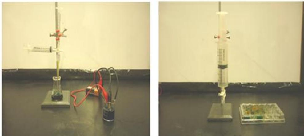
De izquierda a derecha: sistema de microtitulación, sistema de electrocoagulación de aguas residuales, sistema de obtención de gases y microplato de cavidades para pruebas a la gota.
