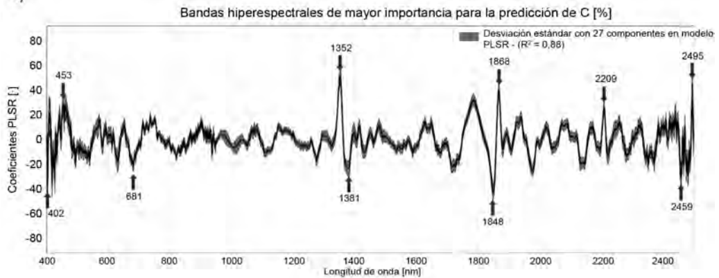
Figura 4. Coeficientes PLSR versus longitud de onda para a) pH del agua, b) Magnesio y c) Carbono. Los coeficientes de regresión PLS pueden utilizarse para seleccionar predictores (longitud de onda) más relevantes de acuerdo con la magnitud de sus valores. Las longitudes de mayor importancia en los modelos PLSR están indicadas por las flechas.
