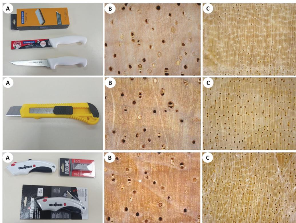
**Fig. 3.** A. Herramientas para el corte de muestras; cuchillo Tramontina, cúter retráctil Pretul y cuchilla Ubermann. B. Imagen macroscópica de *Cedrelinga cateniformis*. C. Imagen macroscópica de *Brosimum alicastrum*. / **Fig. 3.** A. Tools for cutting samples; Tramontina knife, Pretul retractable cutter and Ubermann blade. B. Macroscopic image of *Cedrelinga cateniformis*. C. Macroscopic image of *Brosimum alicastrum*.
