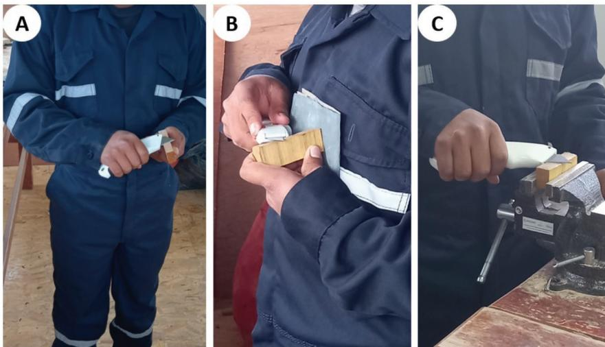
**Fig. 2.** Corte de muestras de madera; A. Posición de corte para maderas duras. B. Suaves. C. muestra fijada en un tornillo de banco. / **Fig. 2.** Cutting of wood samples; A. Cutting position for hardwoods. B. Soft. C. Specimen fixed in a vice.
