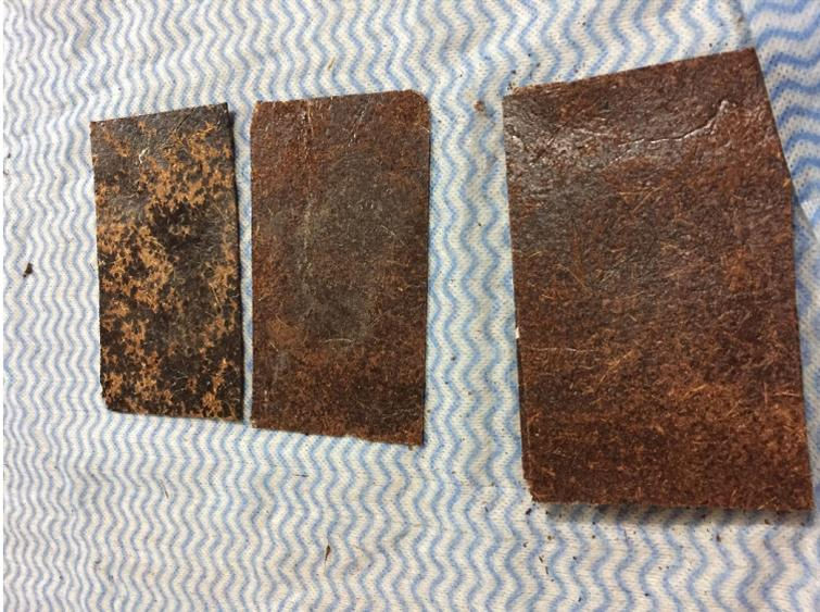
Los datos correspondientes a los ensayos de tracción aplicados a las placas de fibra de coco confeccionadas con PLA como aglutinante se muestran en la tabla 5. Para el análisis estadístico de las pruebas de tracción, se utilizó la prueba de Barlett y se determinó un  $X_o^2$  de 5.03 y un  $X_{(a,k-1)}^2$  de 7,815; por lo que el diseño estadístico posee una varianza constante. El mismo se reporta con un 95 % de confianza.
