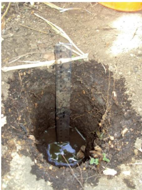
el cual se mide el descenso del nivel del agua dentro del pozo a través del tiempo (Figura 4) (Kessler y Oosterbaan, 1977). Una vez alcanzada la saturación del terreno adyacente al pozo, la velocidad de infiltración será casi constante. Bajo estas condiciones, suponiendo conductividad hidráulica constante y aplicando la ley de Darcy, la infiltración total (Q) será igual a:
