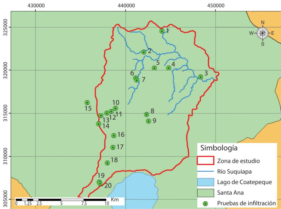
Fig. 1. Sitios donde se realizaron las pruebas de infiltración.
